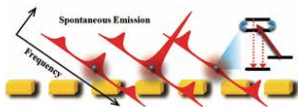
图一：表面等离子激元周期性结构在纳米尺度上对原子自发辐射光谱线宽的周期性调制。
