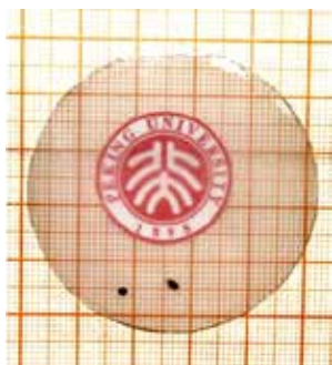
图 1: 通过蓝宝石表面预处理 HVPE 生长的 2 英寸 GaN 自支撑衬底。
